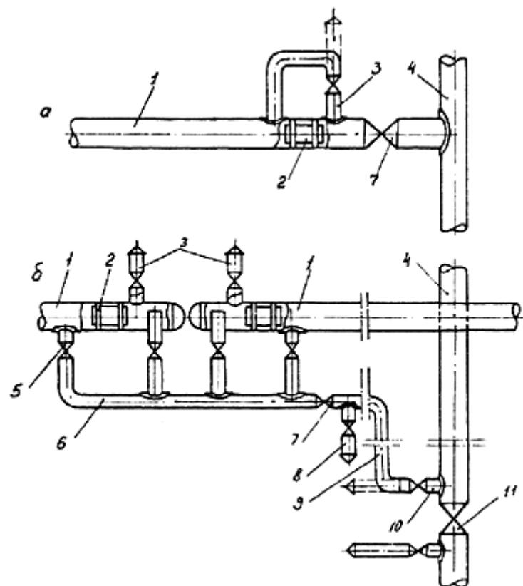
Рис.5. Принципиальная схема подключения для отбора природного газа из действующих газопроводов:
