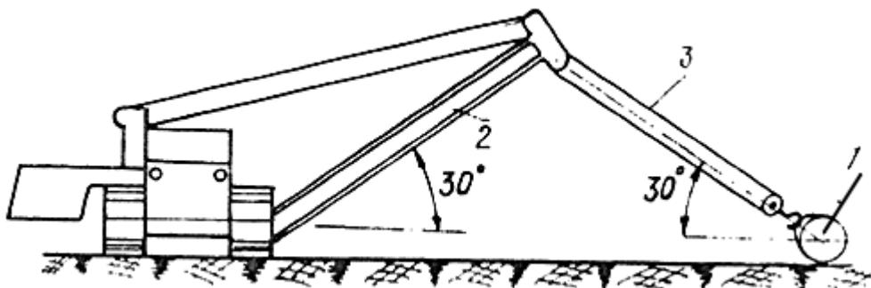
Рис.19. Схема фиксации продувочного патрубка трубоукладчиком:
