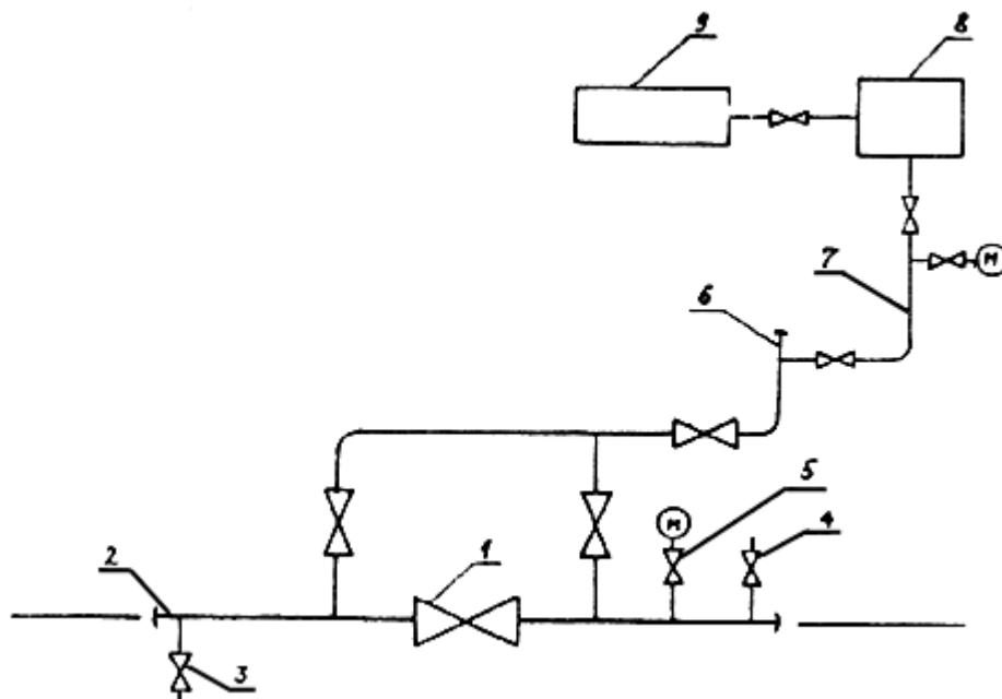
Рис.1. Принципиальная схема предварительного гидравлического испытания кранового узла:
