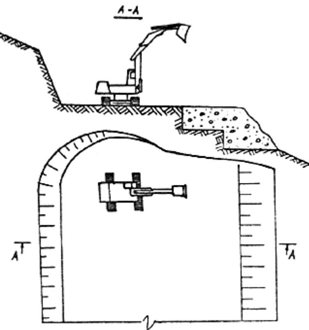
Рис. 4. Схема разработки полок экскаватором
