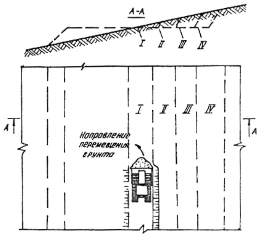
Рис. 3. Схема разработки полок на склонах продольными проходами бульдозера:
