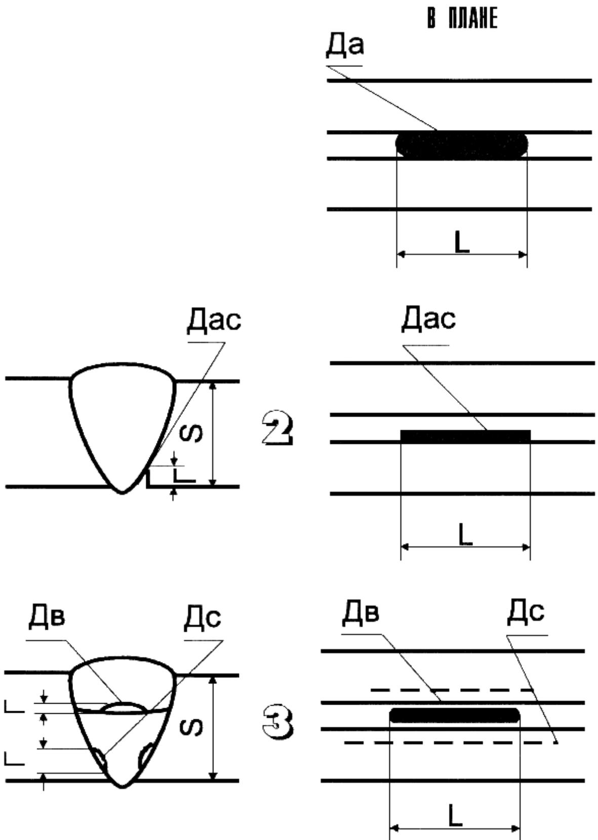
Рис. 7. Схематическое изображение непроваров и несплавлений
