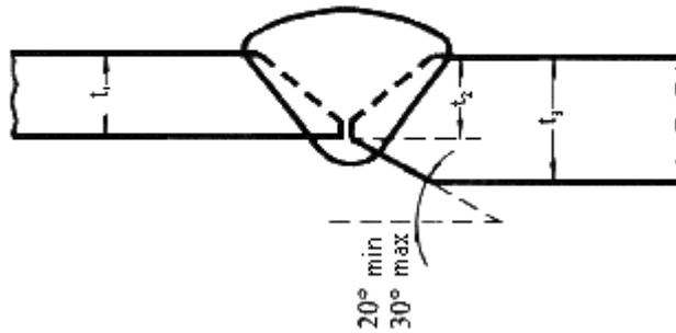
Обработка с внутренней стороны толщины  $t_3$  до  $t_2 = t_1$
