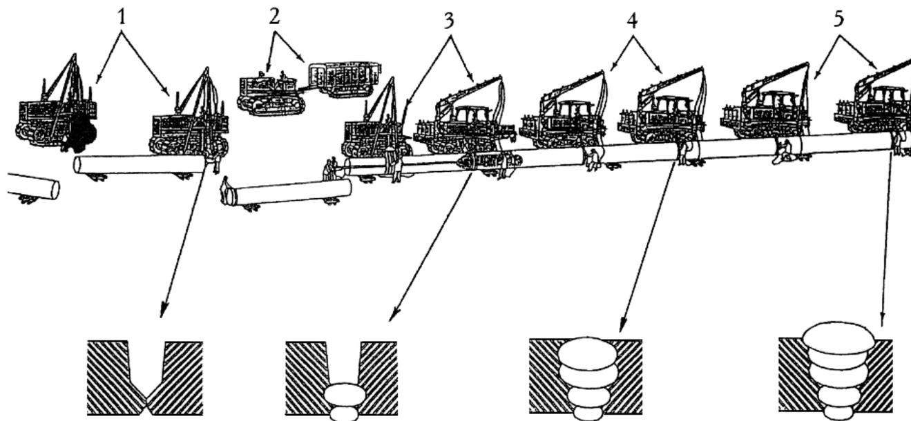
Рис. 4.1.1. Типовая схема организации работ при автоматической сварке стыков на оборудовании "CRC- Evans AW"
