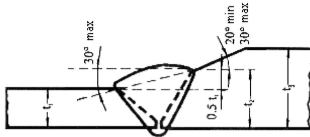
Обработка с наружной стороны толщины  $t_3$  до  $t_2 \leq 1,5t_1$
