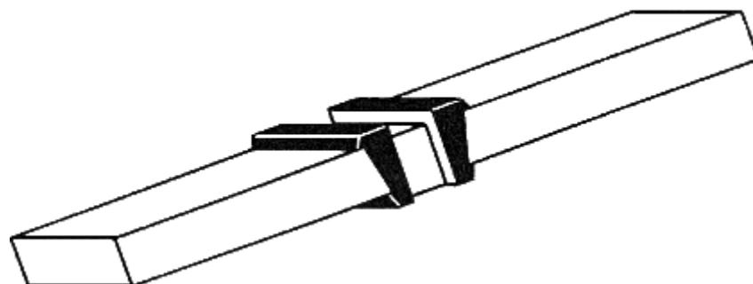
Рис. 4. Образец с надрезами для испытания на излом
