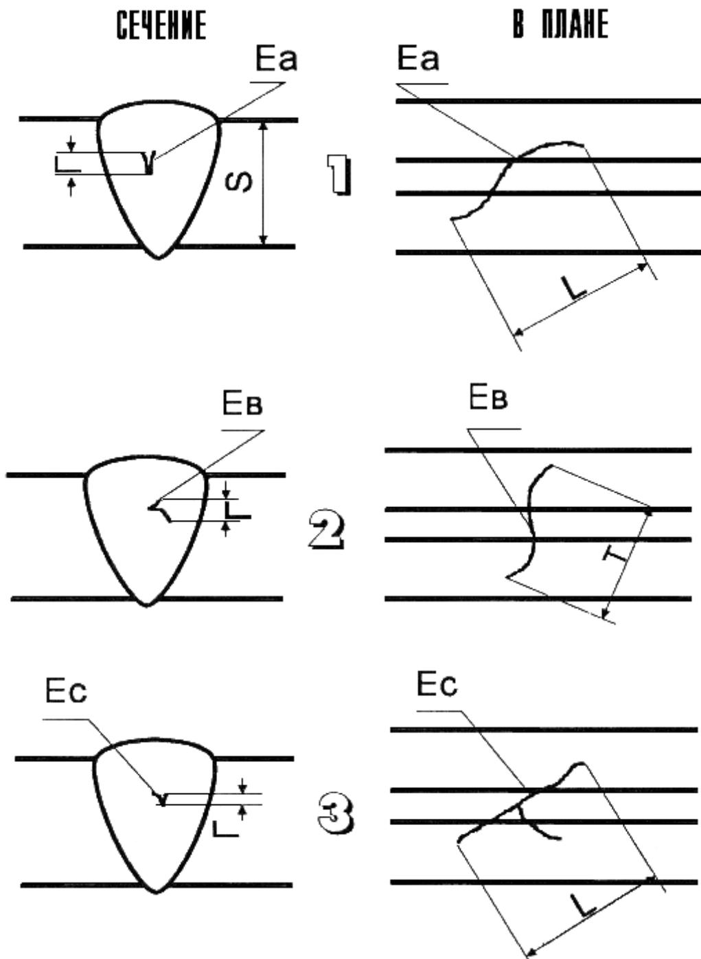
Рис. 8. Схематическое изображение трещин (индекс "Е" согласно табл. 7)
