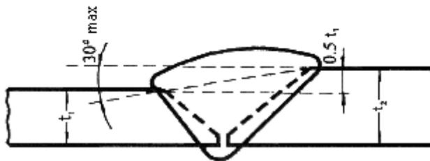
Соединение  $t_2 \leq 1,5t_1$  без обработки свариваемых торцов ( $t_2 = t_3$ )
